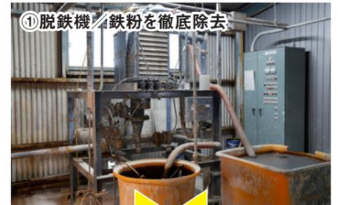
①脱鉄機 / 鉄粉を徹底除去
