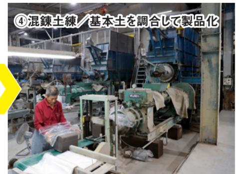
④混練土練 / 基本土を調合して製品化
