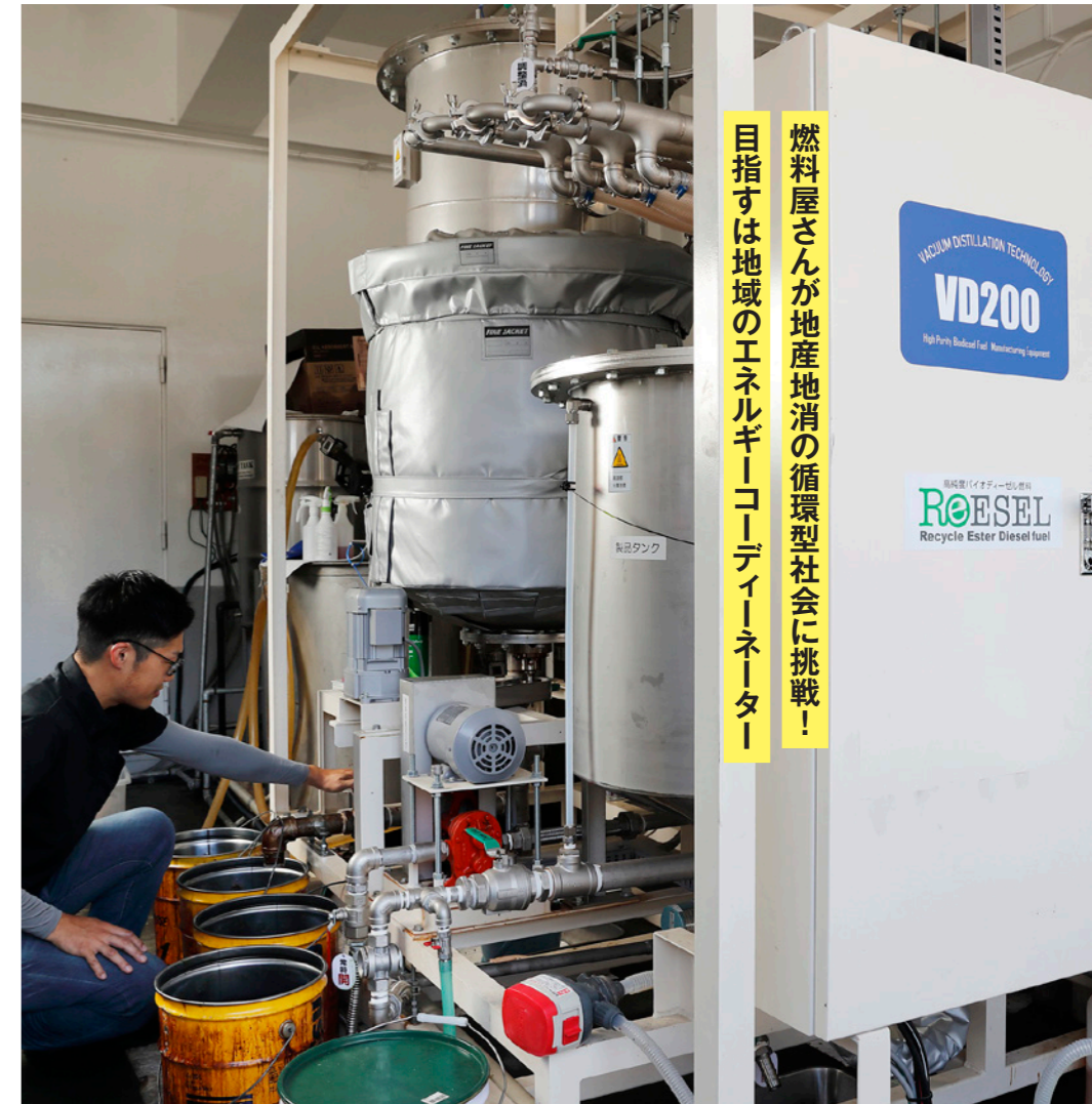
高純度なバイオディーゼル燃料を製造する装置
