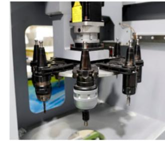
樹脂板を切削加工するためのツール
