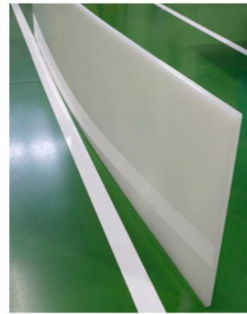
本補助事業では、反りが残る新しい樹脂の加工における生産性を改善する取り組みを実施しました。(1) 加工時間の短縮・吸着力の強化、平坦面の加工、切削速度の高速化などにより、段取りおよび加工時間が113分から85分と大幅に時間短縮できました(25%の改善)。(2) 属人的な作業の削減・以前は加工業者が都度プログラムを作成していましたが、専任者が扱うCAD/CAMからダウンロードする方法に変わり、同一プレート内で同時に多品種を生産することが容易になりました。(3) 生産量の拡大・サイズの大きいプレート(1.2m×2.4mなど)の生産能力が33%増加しました。増産要求があった主要部品については、本事業に取り組み前から比較して今では3倍の能力を確保し、顧客の要求に応えることができるようになりました。
