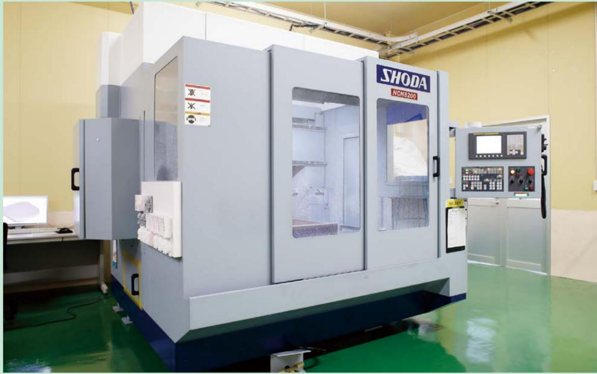
小型精密NCルータマシンNCN8200：X軸Y軸Z軸を制御することによる切削設備
