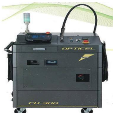
図1.導入したファイバーレーザー溶接機
