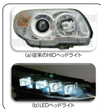
図1. ヘッドライトの形状比較 出典：日経テクノロジーオンライン
