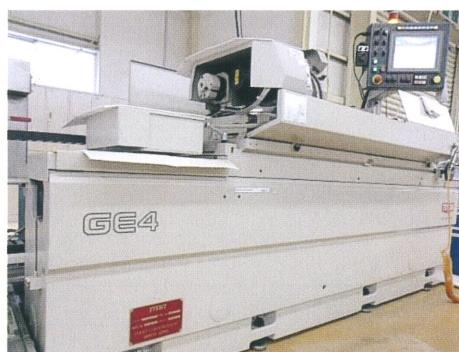
図2 導入したCNC円筒研削盤
